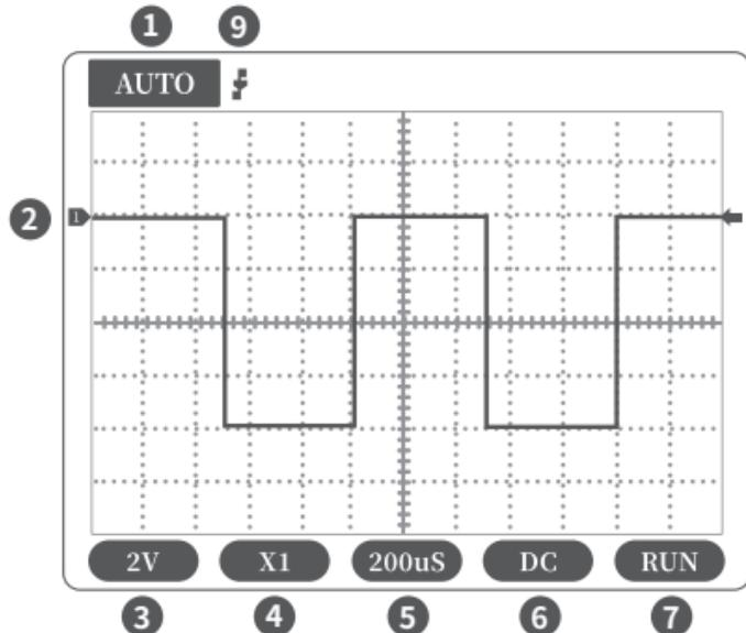
⑤水平时基,表示水平方向一大格代表的时间长度
